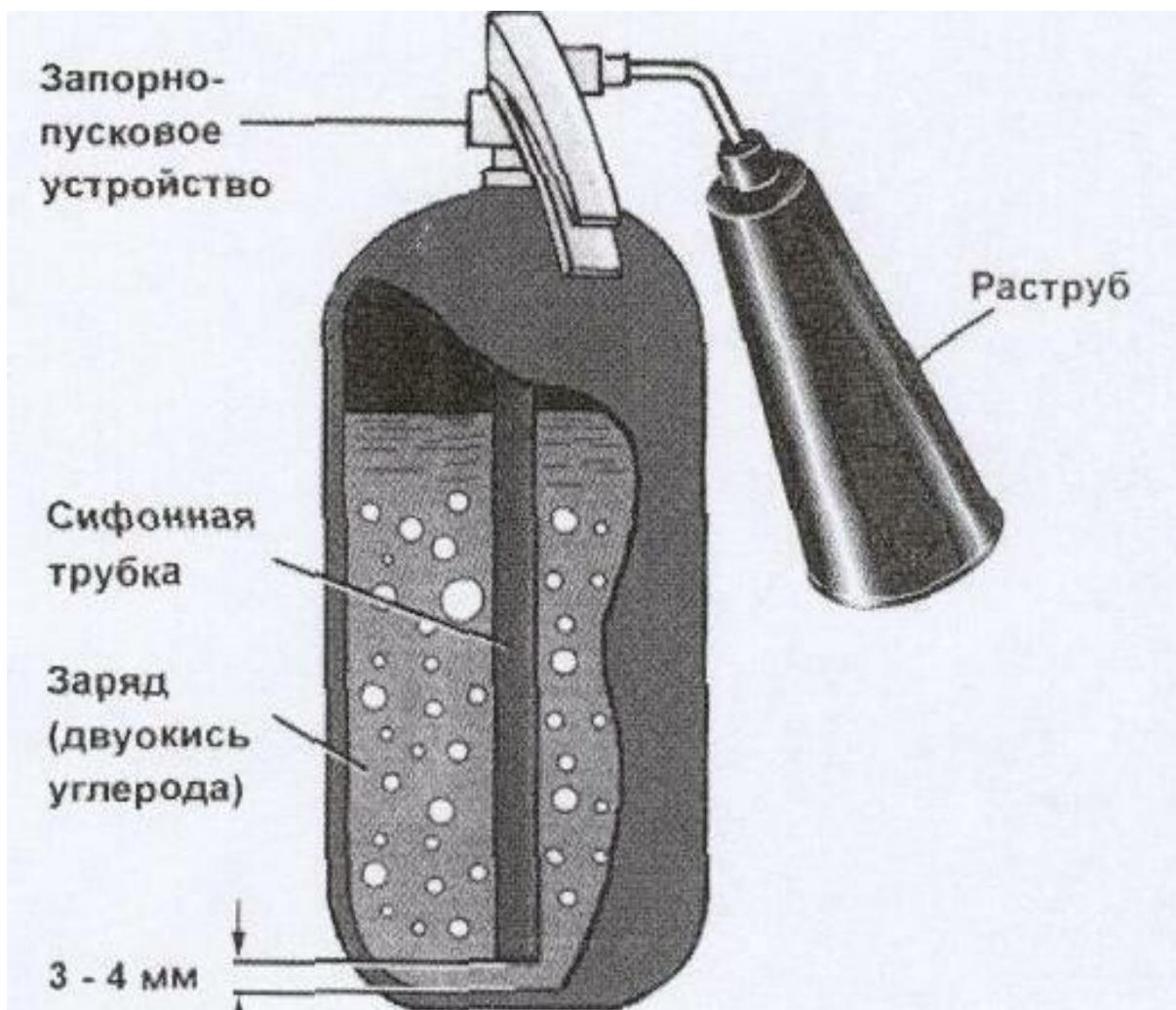
**ПРИНЦИП ДЕЙСТВИЯ** основан на вытеснении из корпуса огнетушителя двуокиси углерода ( $CO_2$ ) избыточным давлением. При открывании запорно-пускового устройства  $CO_2$  по сифонной трубке поступает в раструб. Двуокись углерода под избыточным давлением при взаимодействии с воздухом из сжиженного состояния переходит в твердое (снегообразное) с температурой до минус 70°C.  $CO_2$ , попадая на горящий предмет, изолирует процесс горения от доступа кислорода и резко снижает температуру пламени
