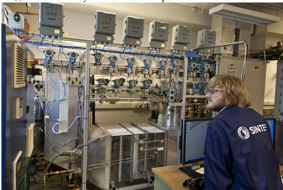
Лабораторные испытания теплообменников и тепловых насосов. Фото: Anne Steenstrup-Duch / Flickr
