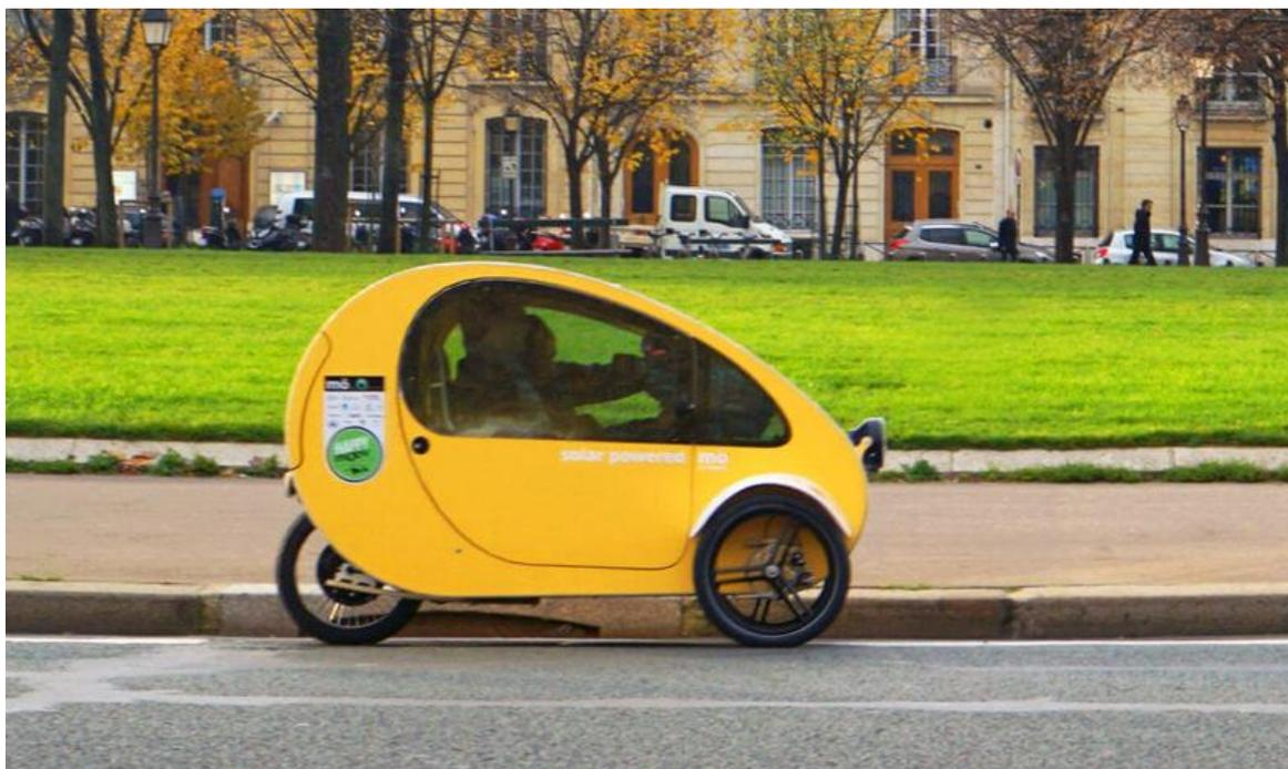
У Mio полная система освещения, указатели поворота, ремни безопасности, заложённая зона лобового столкновения, защита от бокового удара и другие функции безопасности, поэтому можно чувствовать себя вполне комфортно, путешествуя в электроавтомобиле.
