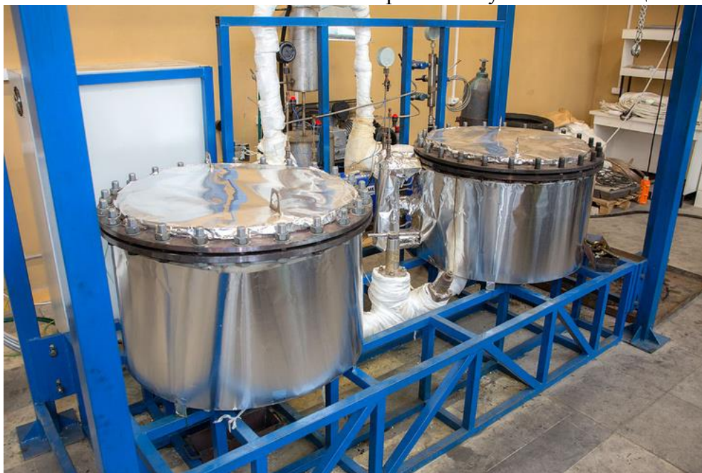
Пиролизная установка для переработки шин в Физико-энергетическом институте Обнинска
